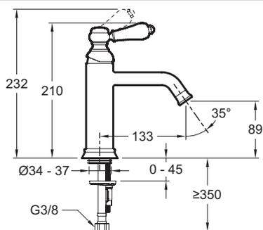
Спецификация продукта : Смеситель для раковины со сливом. E24360. Коллекция : LOUISE. МАТЕРИАЛ : N/A. ТИП УСТАНОВКИ : 1 отверстие. TYPE : Однорычажный. DÉBIT (L/MN SOUS 3 BARS) : 5 л/мин. GARANTIE MÉCANISME : 5 лет. GARANTIE FINITION : 10 лет.
